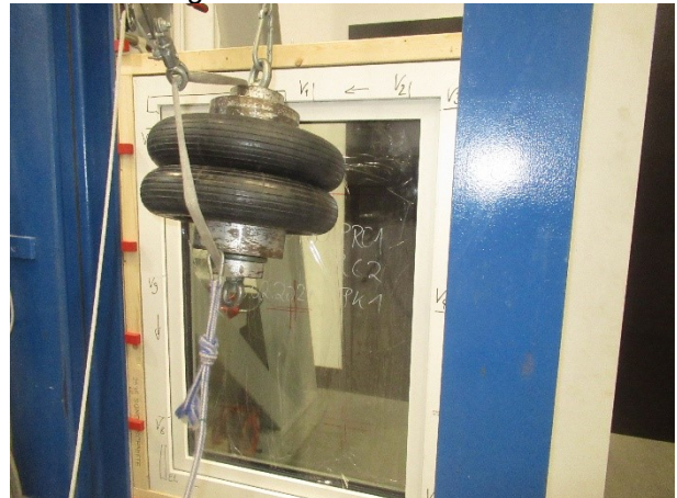
Bild 10 Durchführung der dynamischen Prüfung
