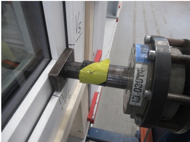
Bild 9 Durchführung der statischen Prüfung
